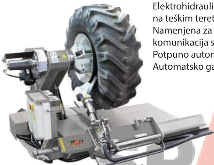
Elektrohidraulična mašina za montiranje/demontiranje pneumatika na teškim teretnim vozilima.
