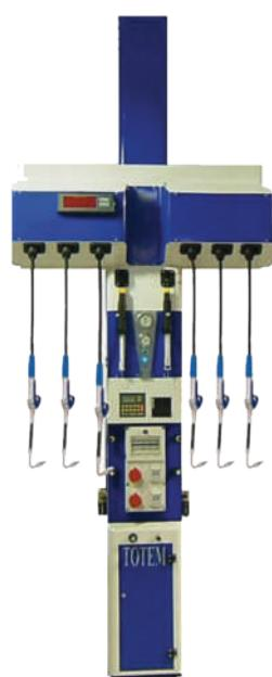
Totem za kontrolisano točenje ulja namenjen za korišćenje više radnih pozicija istovremeno. Kontrolisano korišćenje i merenje doziranja ulja, potpuno automatizovan i povezan sa kontrolnom jedinicom
